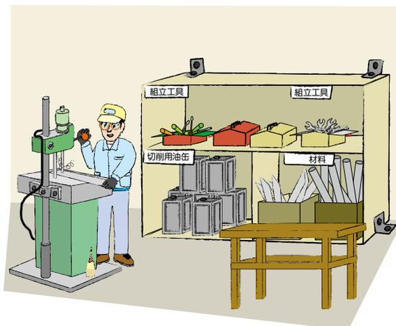
工具、材料等の置き場所を定め、表示して定位置に保管することを徹底した。また、周辺の油こぼれの清掃の徹底を朝のミーティング等で指導することとした。
