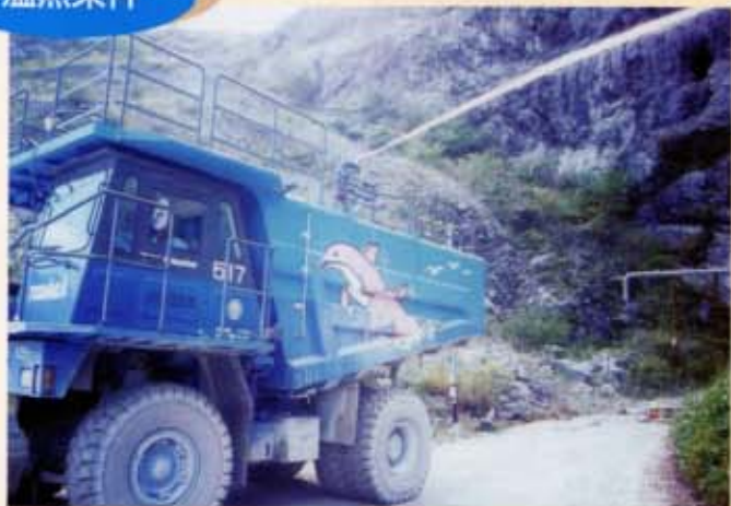
散水車の運転席から散水銃を操作できるようにし、夏季や冬季の寒暖の影響や、粉じんにさらされないようにした。
