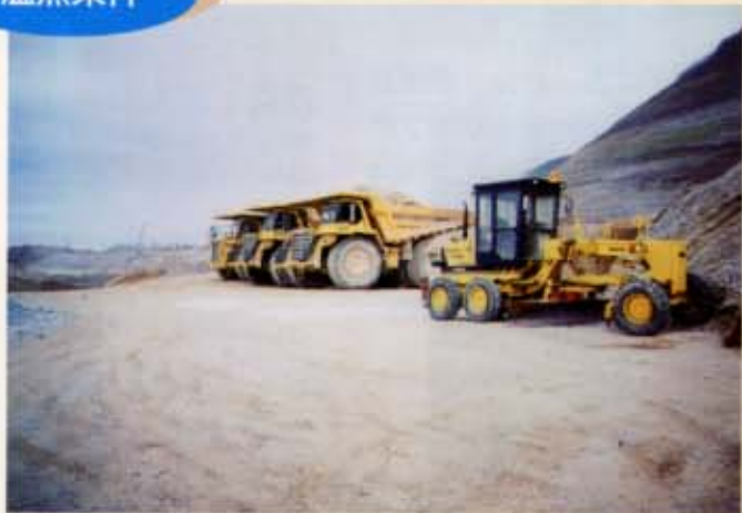
運転席に冷暖房装置を装備したキャビン付きのダンプトラックやホイールローダーを導入して夏季、冬季における寒暖の影響や降雨、降雪、強風等の悪天候による影響を緩和した。
