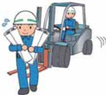
作業員は現場騒音で危険な機械の接近に気がつかず接触。クレーンやフォークリフトの運転者からは、歩いている作業員が死角に居て気がつかず接触事故
