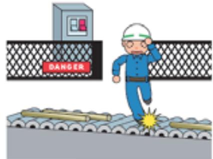
危険な場所で、防護柵などをふくめ設備対策はしているが、トラブル時には製造設備稼働中のままでやむなく立ち入る作業で、挟まれる領域について手足を入れてしまい被災。現場は光電管などの侵入センサーを設置しにくいので注意力しかない
