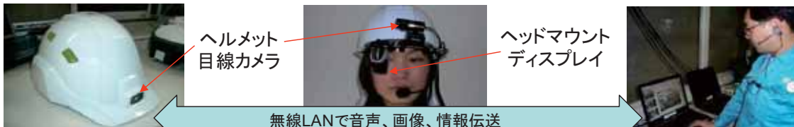
IT各機能の統合組込ヘルメット 高精細目線カメラと眼前ディスプレイ 遠隔からの(一人)作業支援
