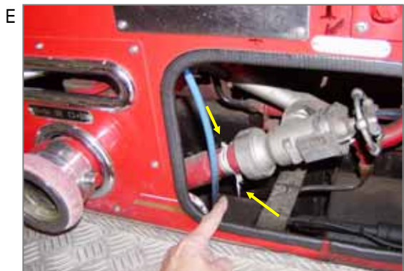
ポンプ車。圧力をかけますので、ゆるいネジ山や継ぎ手があれば水が漏れてしまいます。そこで以前は、石綿糸やテープが使用されており、補修・交換時にはばく露する可能性があります。
